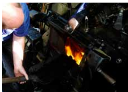
Heizen der Lokomotive auf dem Führerstand
