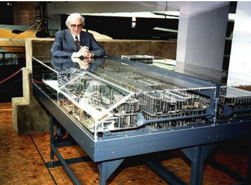
Abb. 8: Nachbau der Z1 im Deutschen Technikmuseum Berlin, Bauzeit 1987-1989. Der Nachbau umfasst ca. 30000 Einzelteile, wie Bleche, Stifte, Federn, Schrauben.
